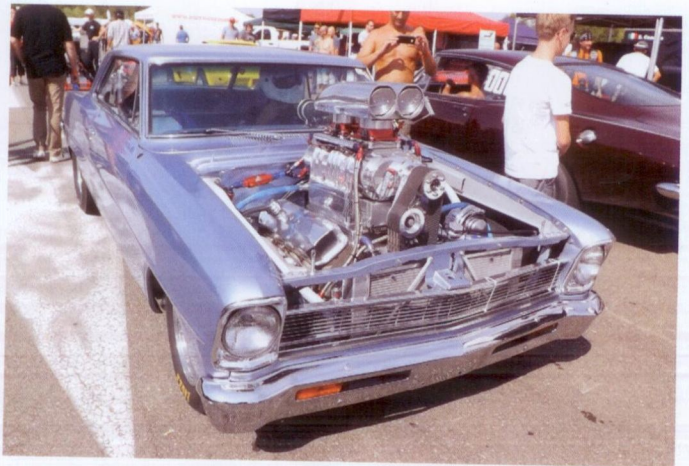
Decisamente impressionante il motore di questa Chevy Nova: un big block alimentato ad iniezione con un grande blower supercharged della BDS.
